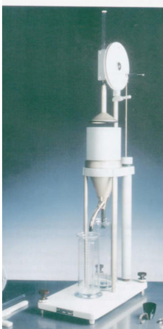
**Schopper-Riegler Mahlgradprüfer - Standardgerät mit 2 Plexiglaszylinder**
